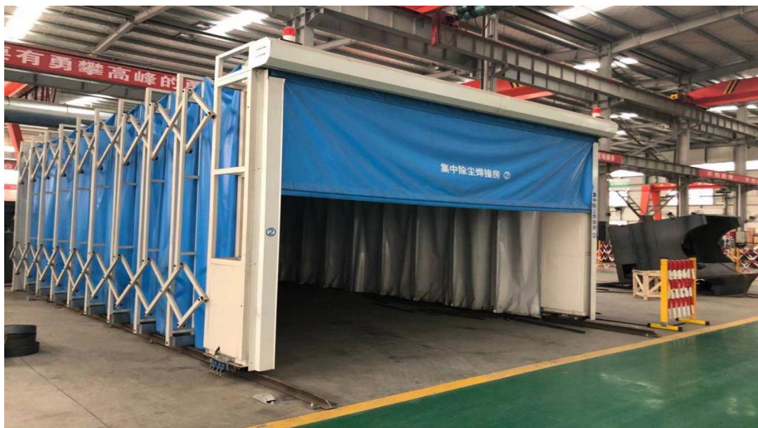
焊接房集中除尘
